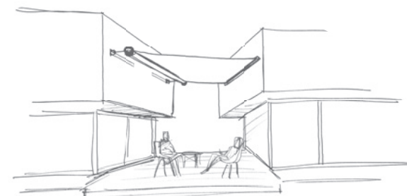
SHADESTRUCTURE | Ausführung Wand-zu-Wand-Verspannung
